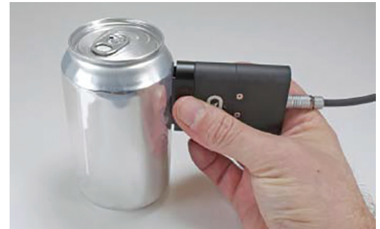
Nota: Área de medición del Flex 20 es 6x6mm. Con adaptadores opcionales de 2x2mm y 4x4 mm para área de medición
