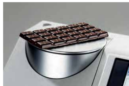
Mediciones de Reflectancia con el CM-5
